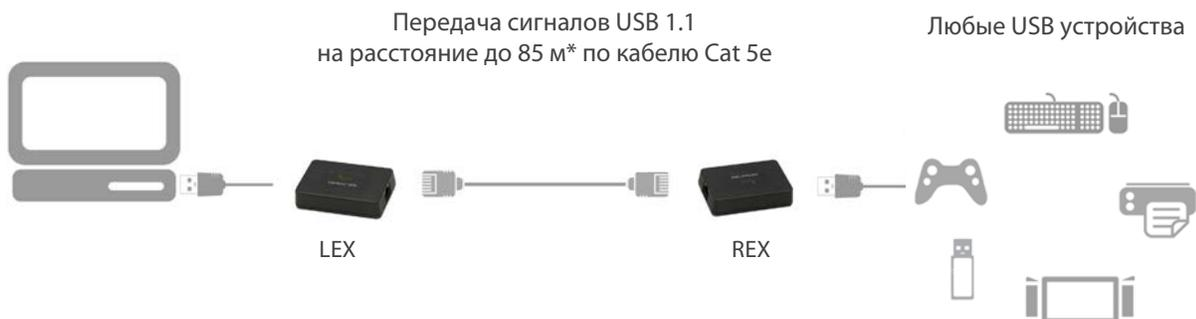
\*До 40 м для всех USB устройств, 85 метров является достигаемым значением при использовании большинства HID USB устройств с малым потреблением питания
